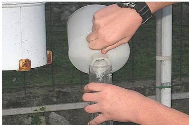
Fig. 1. Pluviómetro (izquierda) y medida de la precipitación recogida (derecha).
